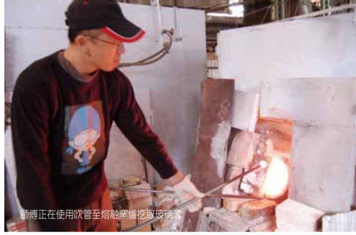
師傅正在使用吹管至熔融窯爐挖取玻璃膏
